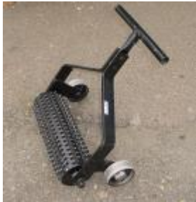
Riffelwalze 65 kg mit 2,5 m langer Stange und Handgriff
