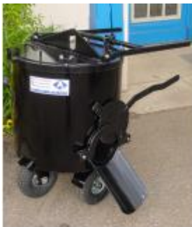
Asphaltkarre große Ausführung, runde Form, isoliert , Inhalt ca. 100 Liter, seitlicher Auslass, 4 x luftbereifte Stützräder, Schiebebügel umklappbar, Krantraverse mit einem Auge
