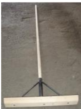
Splittschieber aus Holz komplett montiert mit Stiel Abmessungen: Platte 600 x 120 x 35 mm Stiel 2.000 mm Durchmesser ca. 30 mm
