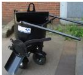
Asphaltkarre große Ausführung, runde Form, nicht isoliert , Inhalt ca. 100 Liter, seitlicher Auslass, 4 x luftbereifte Stützräder, Schiebebügel umklappbar, Krantraverse mit einem Auge
